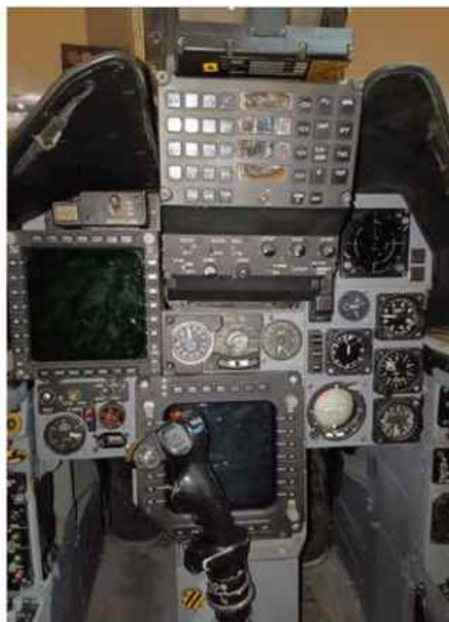
Imagen 1, simulador de vuelo avión Kfir
