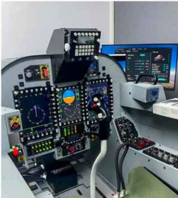
Imagen 2, simulador de realidad mixta avión A-29B
