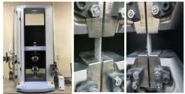
Figura 9 Ensayos a tracción. A) Máquina de ensayos universales SHIMADZU. B) Probeta durante el ensayo a tracción. C) Probeta post-ensayo
