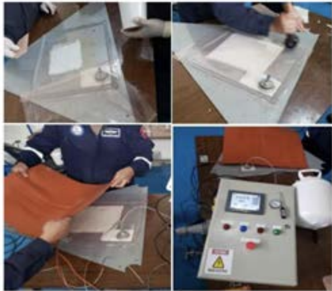
Figura 8 Proceso de laminado y preparación para el curado. A) Laminación. B) Sellado y enfundado. C) Colocación de mantas térmicas. D) Programación del curado en la maleta de curado automático
