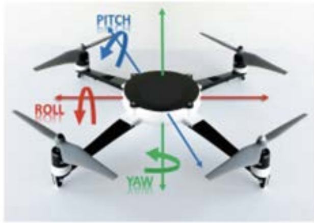
Figura 1 Quadrotor y ejes de rotación [4]
