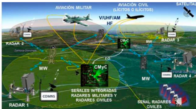
Figura 1. Concepto general de operación del Sistema de Comunicaciones de los CMyc. Fuente: Elaboración del autor.
