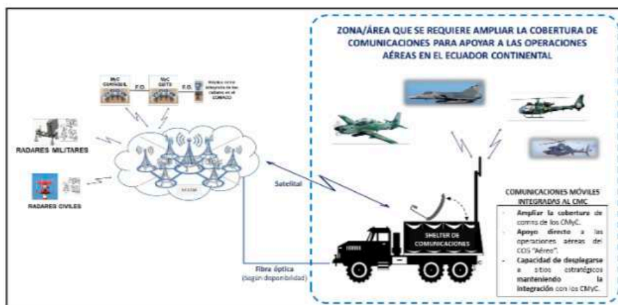
Figura 3. Esquema general para ampliar la cobertura de comunicaciones. Fuente: Diseño del esquema del Autor. Imágenes de aviones y vehículo tomadas de varias fuentes de internet.
