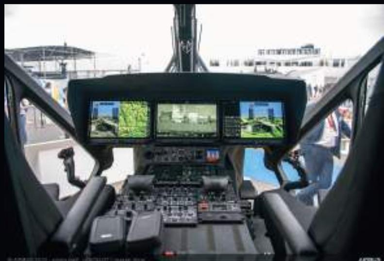
última generación y compatible con el uso de anteojos de visión nocturna, además de contar con altos niveles de automatización que reducen significativamente la carga de trabajo de los tripulantes. Mientras el UH-1Y trae una torreta de sensores (TV, Flir, etc.) de manera estándar, todos los demás pueden ser equipados con una.
