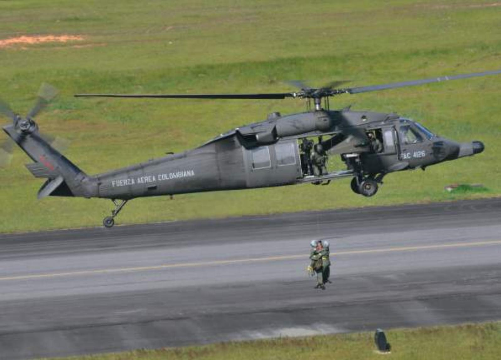
primer AH-60L Arpía, instalando el ESSS (External Stores Support System) para llevar dos ametralladoras M-3P de 12,7mm y dos lanzacohetes LAU-61.
