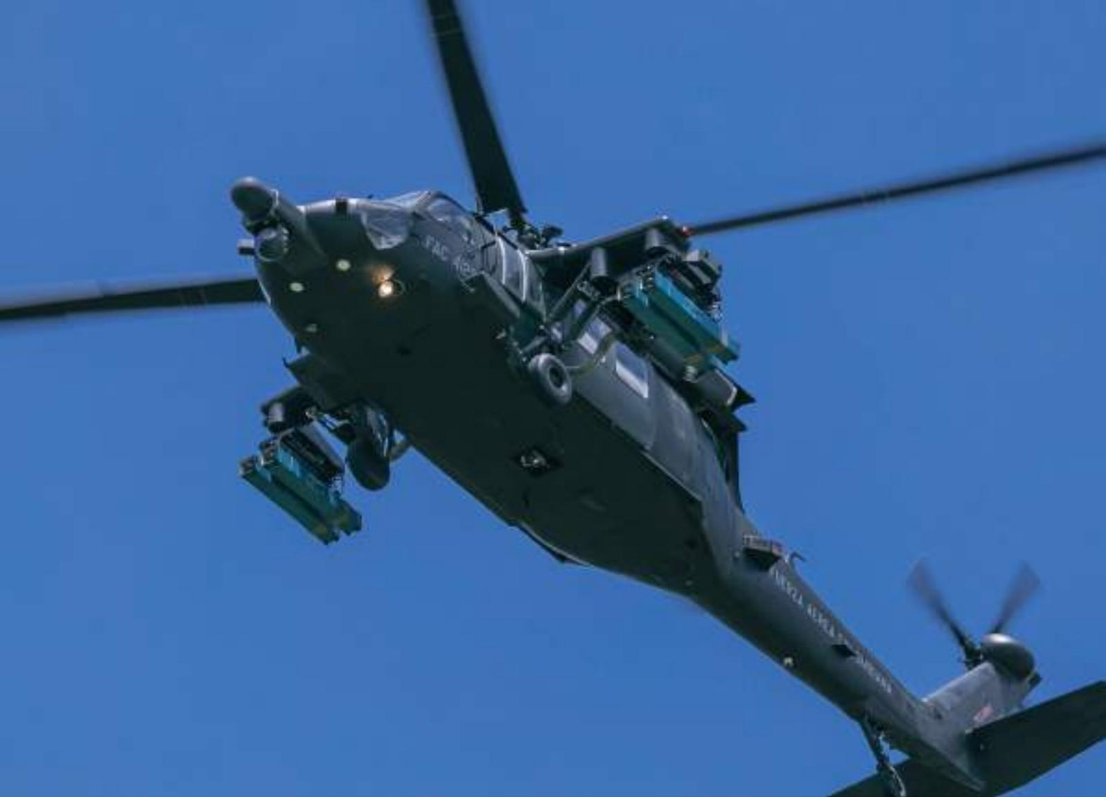
Arriba: Arpía IV en configuración Alfa Thor, con dos GAU-19A y cuatro misiles Spike NLOS. La variante NLOS es la de mayor alcance del Spike, con hasta 25 kilómetros de alcance efectivo, lo que le permite no solo hacer ataques directos, sino con una navegación hasta el blanco, de manera de ocultar la posición del helicóptero o atacar desde distintas direcciones. El peso del misil es de 71 kilos y el del lanzador es de 70 kilos. Foto: Erich Saumeth.
