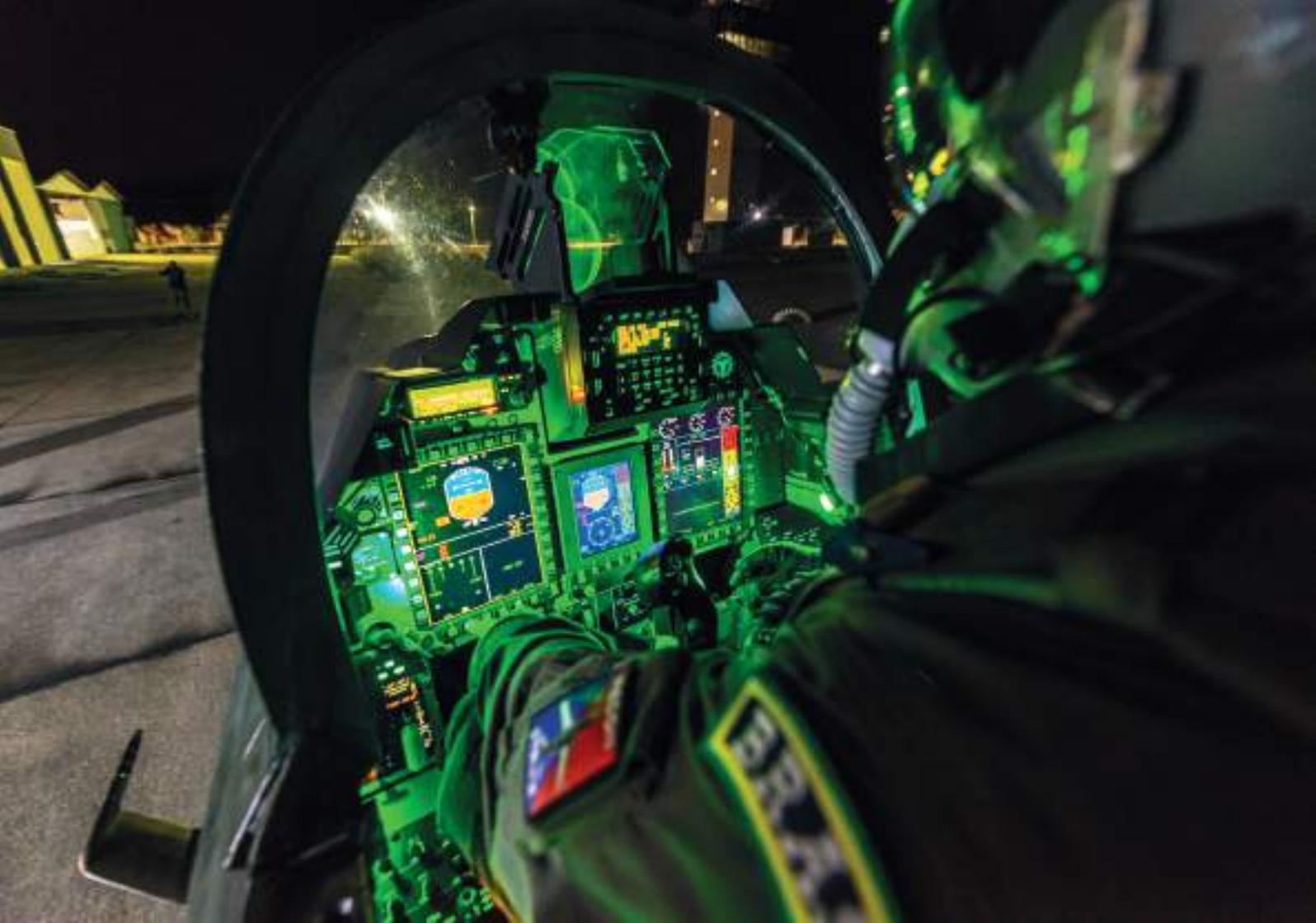
Transfer Cartridge (DTC). Las imágenes del MFCD y el HUD se grababan en cinta para analizar el ataque y el debriefing de la misión.
