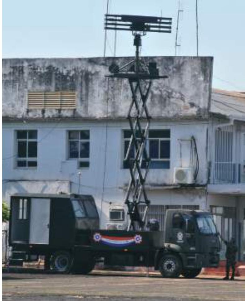
Uno de los radares ELTA comprados para vigilancia fue montado sobre un camión modificado localmente. El otro radar está instalado de manera fija para dar cobertura a una parte del espacio aéreo paraguayo.
