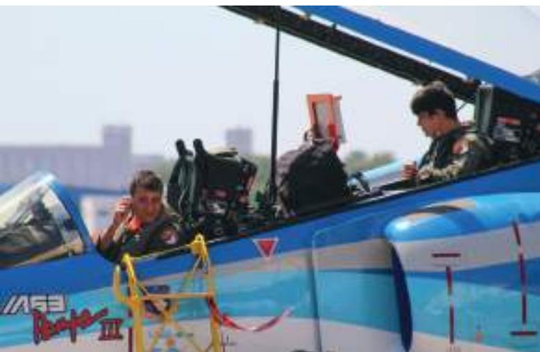
Arriba: Cabina del EX-03 donde se puede ver la pantalla agregada para controlar los parámetros de las vibraciones durante las pruebas.
