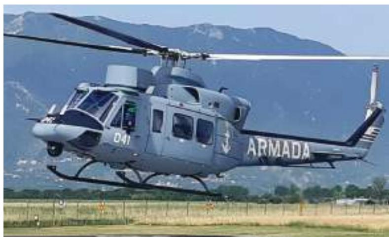
Topo: El 041 durante su inspección en Italia. Se puede ver la antena del radar, así como la torreta de sensores.
