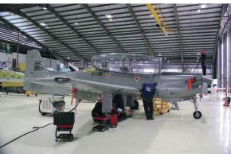
uniones entre el fuselaje con los planos y se reforzó la unión del fuselaje con el estabilizador horizontal.
