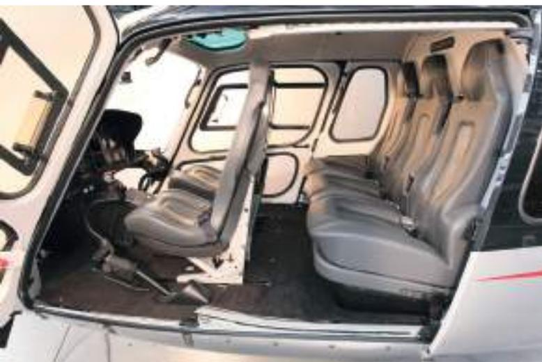
**Topo:** Cabina trasera del Bell 407, con la disposición de asientos para hasta cinco personas. Adelante puede ir el piloto y otro pasajero o dos pilotos.
