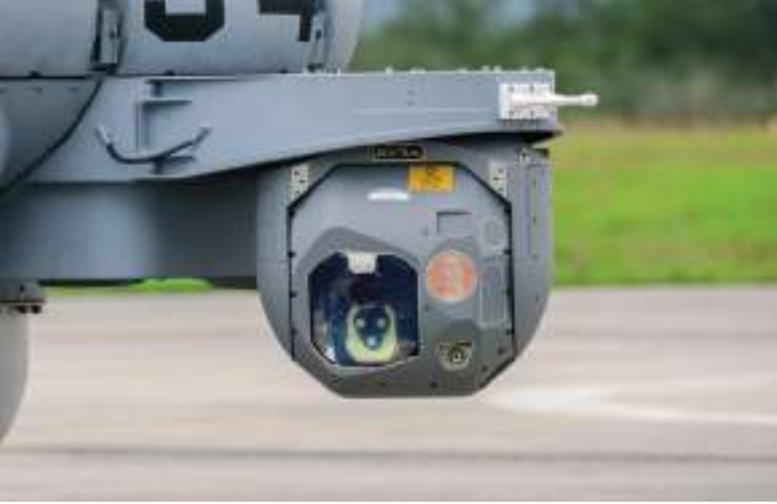
**Arriba:** El sensor AN / AAS-44 V EO / IR proporciona imágenes a una distancia de hasta 40 km del objetivo, convencional e infrarrojo.
