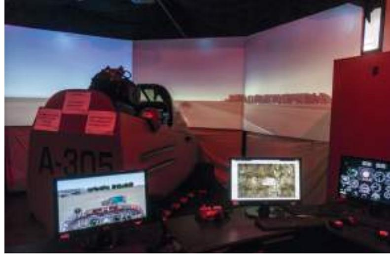
**Arriba:** El simulador del Pucará fue enteramente desarrollado por el personal de la propia III Brigada Aérea, con ayuda de otras áreas de la fuerza, empleando la parte delantera de la cabina de un Pucará dado de baja. Detrás del panel de instrumentos se instaló una pantalla que a través de los agujeros del panel original muestra la representación de los instrumentos como si fueran reales.
