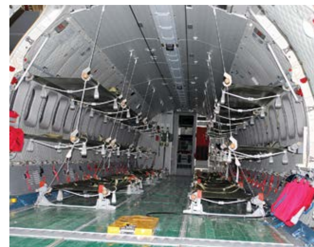
Interior del avión Casa C-295M adaptado para evacuaciones aeromédicas.
