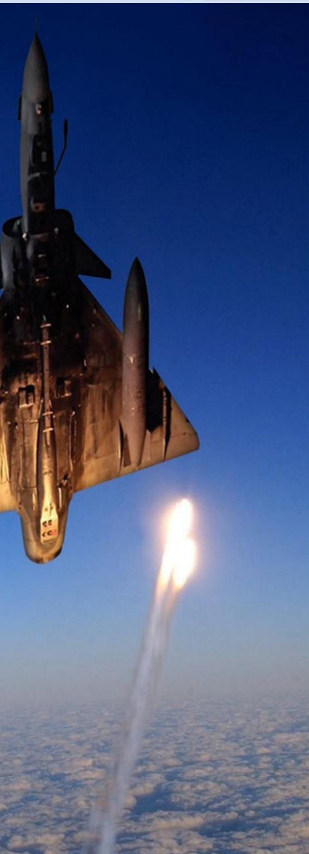
aeronave mediante eyección mecánica o pirotécnica. La eyección mecánica descarga los Chaff utilizando pequeñas cajas de cartón laminadas de aluminio.
