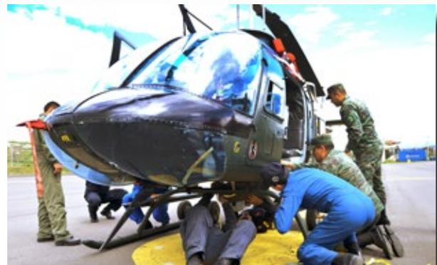
Instalación de sistema EO prototipo en aeronave TH-57
