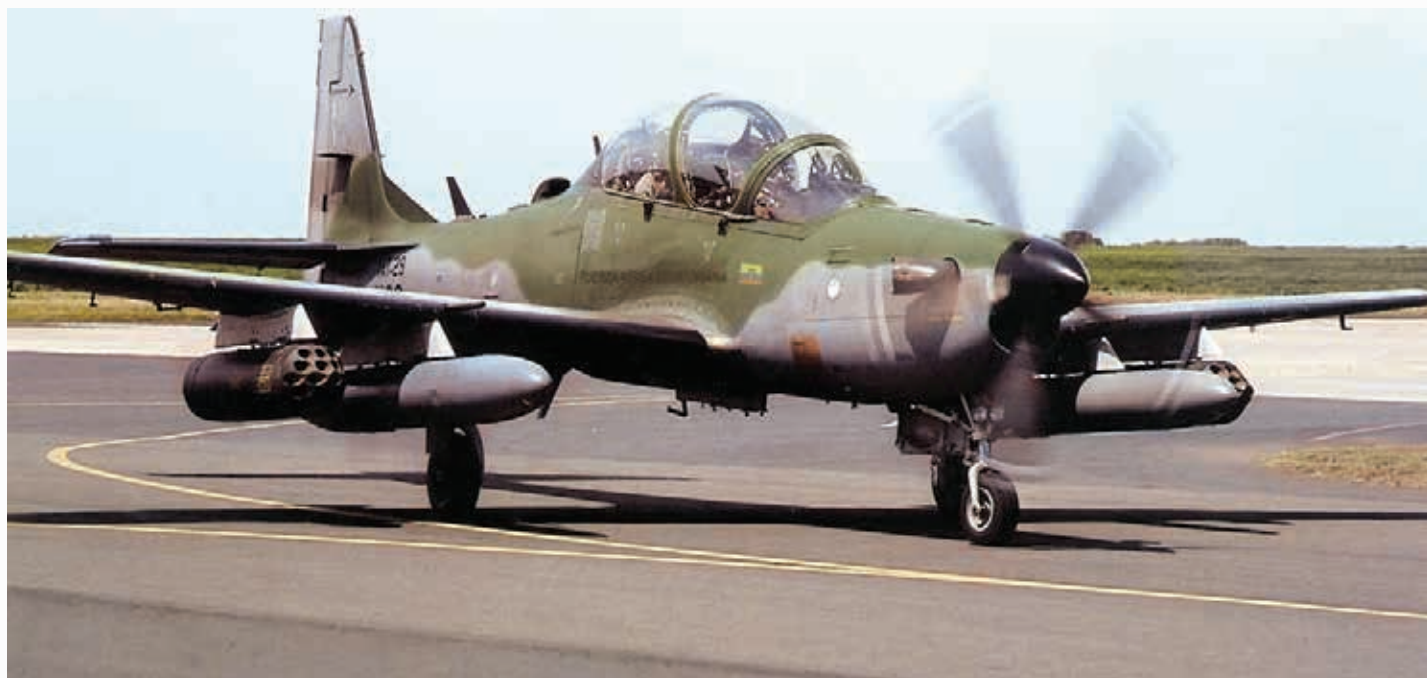
Este avión puede operar en los más difíciles ambientes como pistas no preparadas, en el día y en la noche. Las especialidades básicas en cuanto a dimensiones son las siguientes: Largo: 11,38 m - Envergadura: 11,14 m - Altura: 3,97 m.
