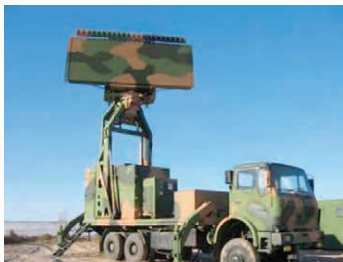
El YLC-18 es un radar de vigilancia fabricado en la China; cuenta con tecnología de punta y un alcance de detección superior a las 100 millas náuticas, para amenazas aéreas de muy baja superficie de refracción y muy bajo nivel.
