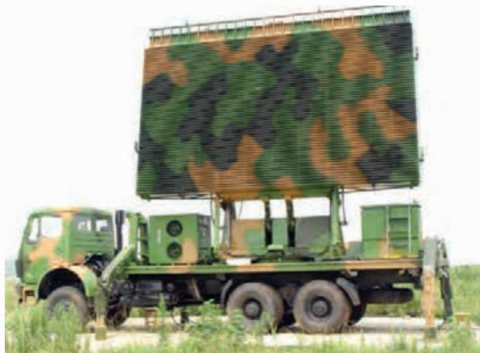
El YLC-2V es un radar de vigilancia fabricado en la China; cuenta con tecnología de punta y un alcance de detección superior a las 230 millas náuticas, para amenazas aéreas de muy baja superficie de refracción.
